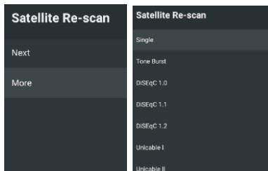
Ha további kérése van műholdra, válassza a Több lehetőséget a műholdantenna típusának beállításához, pl single, Tone Burst, DiSEqC és Unicable.
