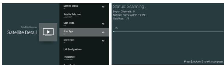
Apăsați OK pentru a intra în setările parametrilor sateliților, care includ LNB POWER, LNB Frequency, DiSEqC Set, 22K și alți parametri.
