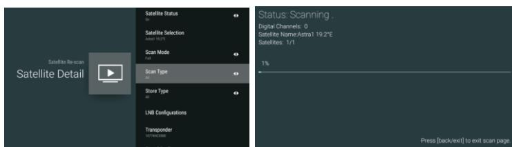
Naciśnij OK, aby przejść do ustawień parametrów satelity, które obejmują MOC LNB, LNB Częstotliwość, zestaw DiSEqC, 22K i inne parametry.
