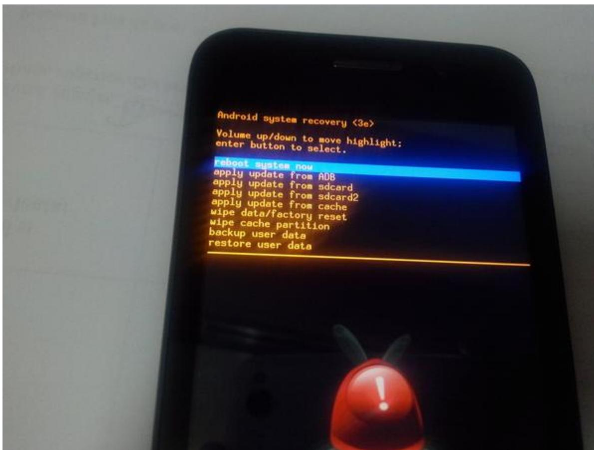
In secventa de recovery aparuta navigati utilizand tasta „Volum -” pana la optiunea „apply update from sdcard” si confirmati cu tasta „Power”.
