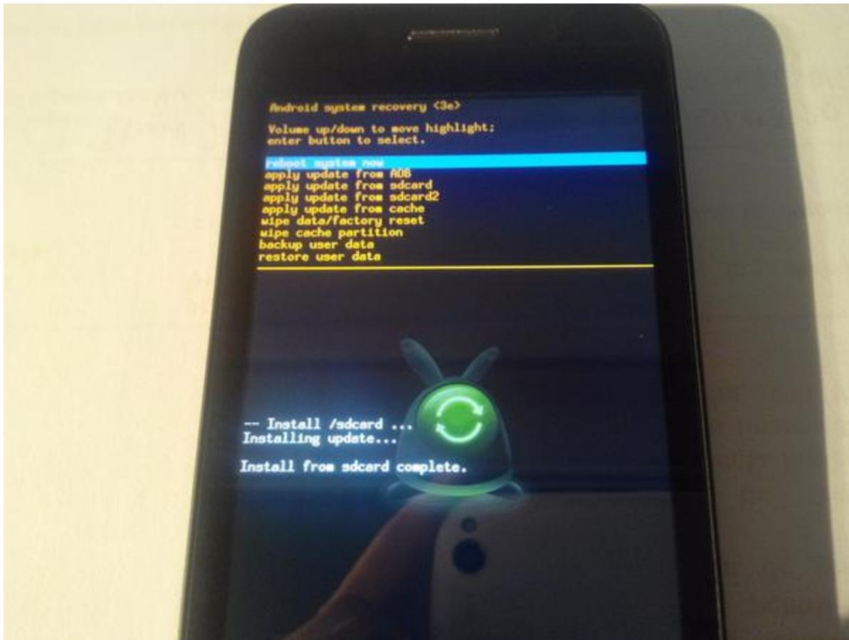
Dupa operatiunea de actualizare a versiunii de soft recomandam resetarea la parametrii de fabrica accesand Setari > Copie de rezerva si reinitializare > Resetarea configurarii din fabrica > Resetati telefonul.
